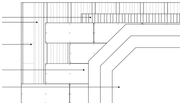
Nel caso di strutture isolanti può essere corredata da materiali ad elevato sfasamento termico come la nostra fibra di legno **Fibertherm®** o le nostre **fibre sfuse** poste nell'interasse. Il sistema include la fornitura di accessori, profili di partenza, angolari, viti autopercoranti. Collante rasante raccomandato e rivestimento.
