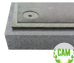
Pannello in polistirene densità relativa 14÷16 kg/m<sup>3</sup> | Conduttività termica dichiarata  $\lambda_D$ [W/(m\*k)] 0,031 | Calore specifico c 1.450 J/kg K
